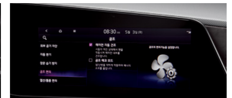
애프터 블로우 ※ EV 전용 에어컨 작동 시 발생하는 응축수를 건조하여 냄새 발생을 사전에 방지하도록 해줍니다.
