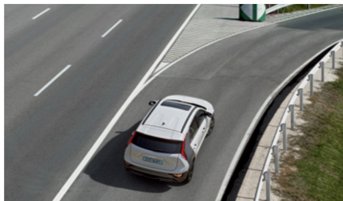
내비게이션 기반 스마트 크루즈 컨트롤 (진출입로) ※ EV 전용 고속도로 및 자동차 전용도로로 진출입로 주행 시 속도를 적절히 조절하여 안전한 주행을 도와줍니다. 이후 진출입로 구간을 지나면 원래 설정한 속도로 주행합니다.
