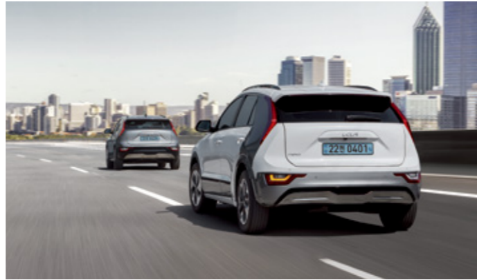
고속도로 주행 보조 2 (차로변경 보조 기능 포함) ※ EV 전용 고속도로 및 자동차 전용도로로 주행 시 앞차와의 거리를 유지하며 운전자가 설정한 속도로 곡선로에서도 차로 중앙을 유지하며 주행하도록 도와줍니다. 주행 중 옆 차량과 가까워지는 경우 위협하지 않도록 차로 내 편향 주행을 합니다. 일정 속도 이상으로 주행 시, 스티어링 휠을 잡고 방향지시등 스위치를 변경하고자 하는 차로 방향으로 움직이면 자동으로 차로를 변경합니다.
