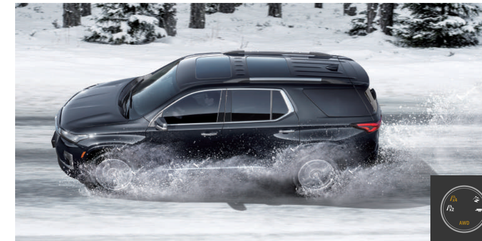
일반도로 주행 시 FWD X2 모드 비나 눈길의 미끄러운 도로 주행 시 AWD X4 모드 비포장 도로의 험로 주행 시 통합 OFFROAD 모드 트레일러나 짐 적재 주행 시 토우/홀(견인/운반) 모드
