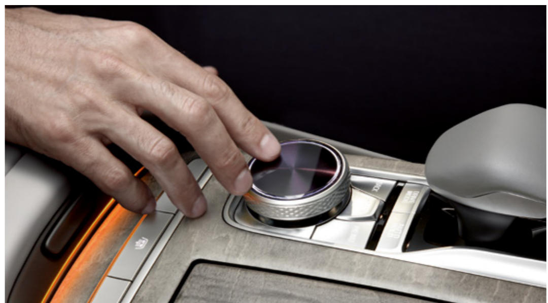
필기인식 통합 컨트롤러
